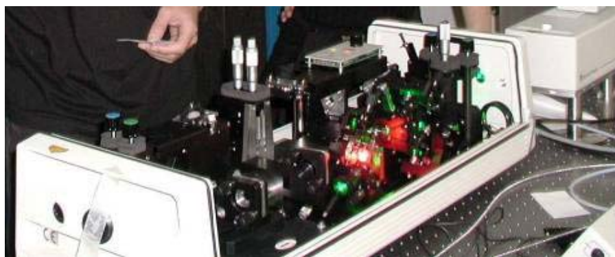
Slika 6. Unutrašnjost fs lasera Tsunami u Laboratoriju za femtosekundnu spektroskopiju Instituta za fiziku
