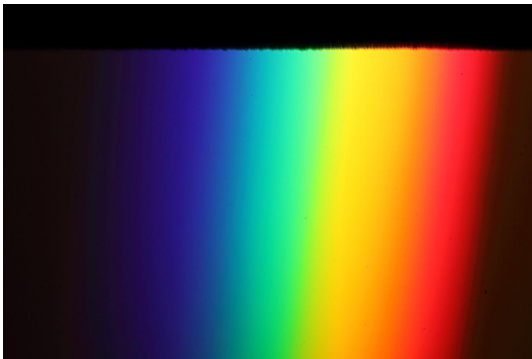
Slika 5 - Kontinuirani spektar žarulje sa žarnom niti
