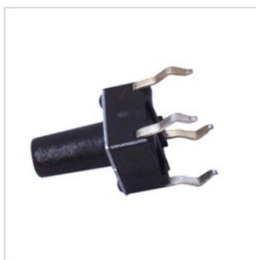
Minijaturna tipka za tiskane pločice, kvadratna, s četiri izvoda.
