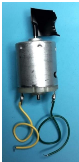
Slika 1. Na izvode elektromotora valja zalemiti žice, a na vratilo treba zalijepiti komad izolirajuće trake
