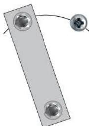
Položaj kontaktnog lima- zatvoren strujni krug preko prvog kontakta
