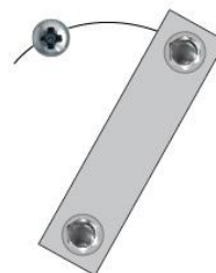
Položaj kontaktnog lima- zatvoren strujni krug preko drugog kontakta
